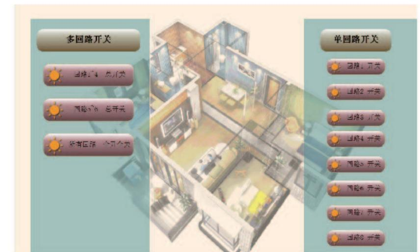
触摸屏端中控，主要应用在一些中小型规模的智能照明控制系统中。触摸屏的控制页面不显示任务栏，可通过上拉选择具体楼层房间，然后选择对应的控制页面，实现远程集中控制功能，如：开关控制、状态实时反馈、调光控制、场景控制、定时控制等。
