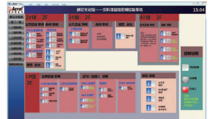
智能照明电脑端中控，广泛应用在智能建筑、体育馆、机场等需要多层次照明控制的场合。电脑端中控的控制页面主要由标题栏、任务栏及工作界面组成。
