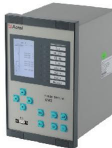
■ 提供12路交流输入（标准硬件包括：三相保护电流、两个零序电流、三相测量电流及4个电压通道），16路可编程有源开关量输入，10路可编程无源开关量输出，可满足绝大多数场合下中低压系统间隔层的保护测控要求。
